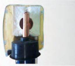
Al – Si Wool & PU – Foam Insulation
